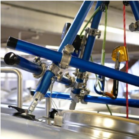
Saugfüsse mit Anzeige für sicheren Halt.
